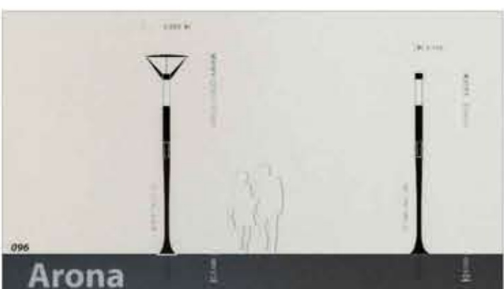
Palo illuminazione Il palo è costituito da un basamento e da due colonne in fusione di ghisa, all'interno delle quali si trova un'anima in acciaio zincato a caldo predisposta per essere cementata in un blocco di fondazione. Ciascuno dei due bracci è in PFAA, bianco, con la possibilità di illuminare con differenti colori. Vite e bulloneria sono in acciaio INOX. Ogni parte del palo verrà preparata alla verniciatura finale attraverso diverse fasi di lavorazione ed almeno due strati di primer atti ad accogliere e proteggere la finitura finale del colore.
